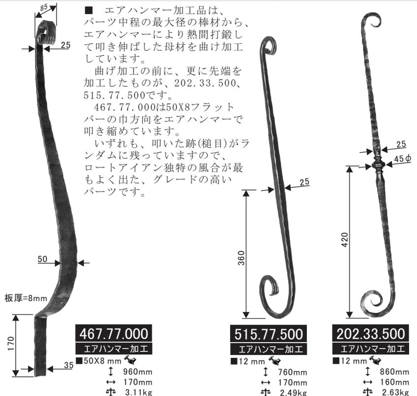
■ エアハンマー加工品は、パーツ中程の最大径の棒材から、エアハンマーにより熱間打鍛して叩き伸ばした母材を曲げ加工しています。
