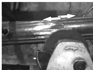
⑤ その後はサンダーをハンドレールの長手方向に動かして、溶接跡をなじませて行くとうまく仕上がります。
