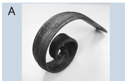
A 【黒皮のままのパーツ】 ※熱間加工時の酸化被膜＝黒皮 黒灰色に茶色が混じったような不均一な色をしています。 (主なパーツ:長尺材やヤクモノ、葉・花の一部)
